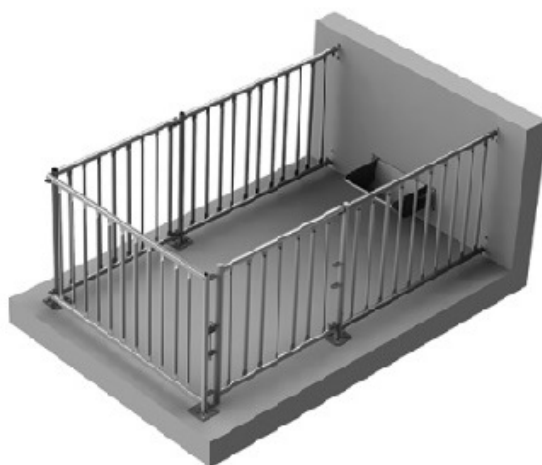
Рис. 2. Удосконалений станок для індивідуального утримання кнура-плідника
