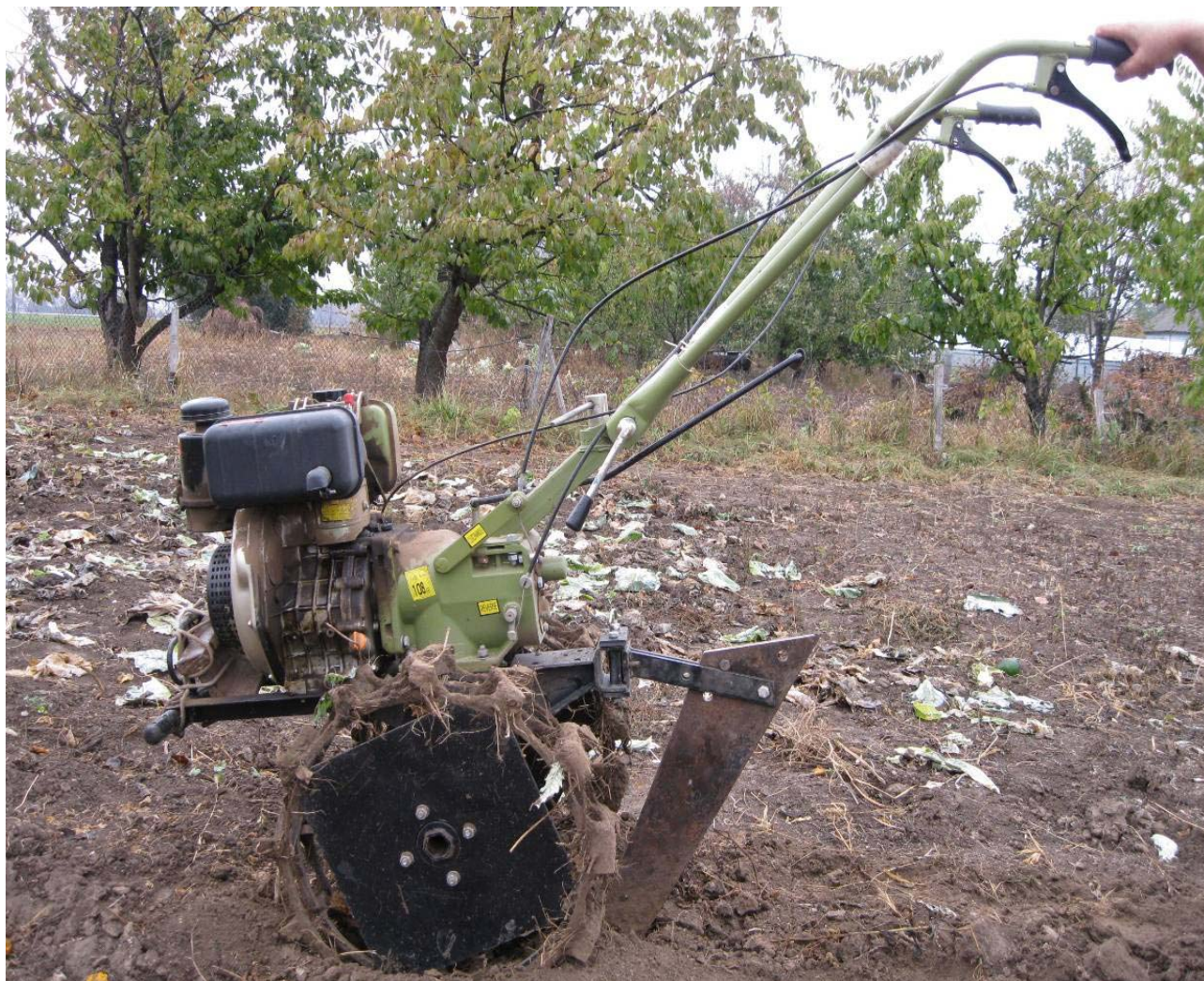
Рис. 2. Ґрунтообробний агрегат у складі запропонованого робочого органу та мотоблоку ZIRKA IZ 105
