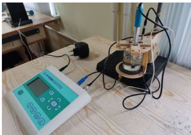
Рис. 4. Лабораторний рН-метр для визначення кислотності досліджуваного субстрату
