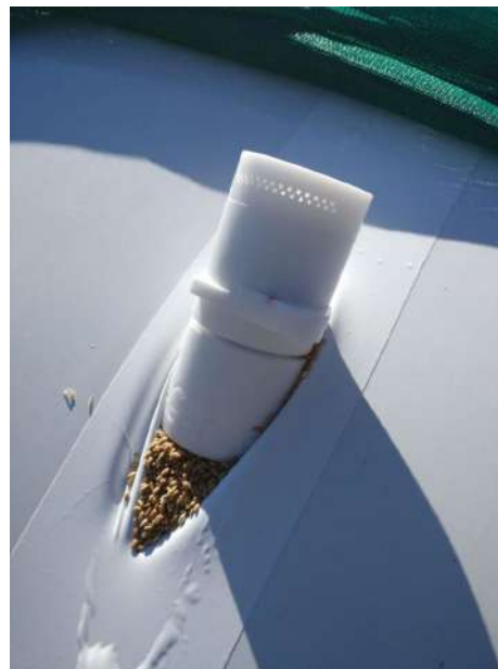
Рис. 3. Розміщення бездротового датчика в полімерному рукаві Джерело: [12].
