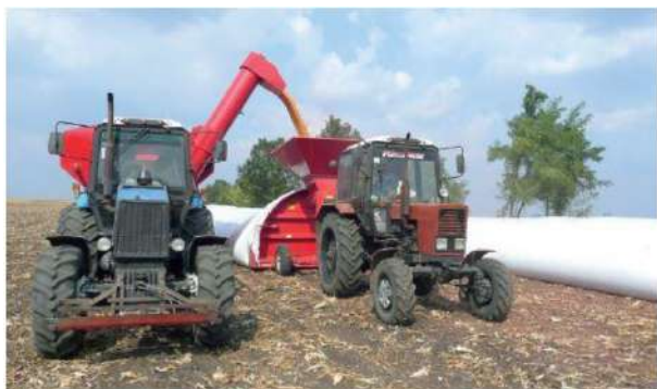
Рис. 2. Закладання зерна на зберігання в полімерні рукава
