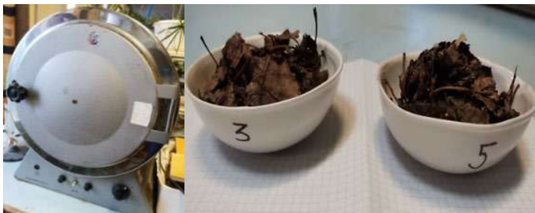
Рис. 3. Визначення вологості компостних зразків
