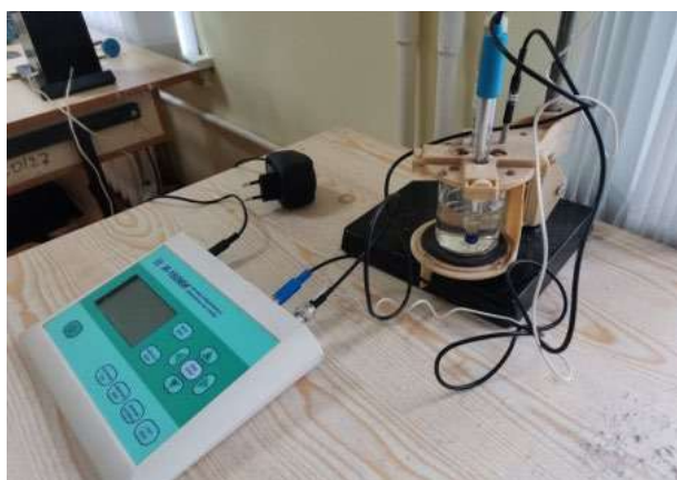
Рис. 4. Лабораторний рН-метр для визначення кислотності досліджуваного субстрату
