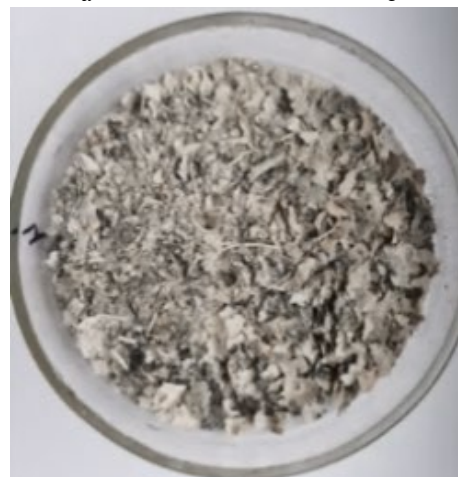
Рис. 5. Визначення зольності проби із біологічними агентами Saccharomyces cerevisiae та Actinomyces а – муфельна піч; б – термічна обробка проби; в – зольний залишок проби
