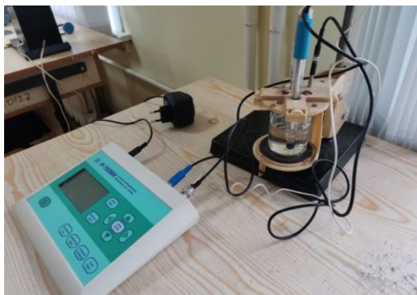
Рис. 4. Лабораторний рН-метр для визначення кислотності досліджуваного субстрату
