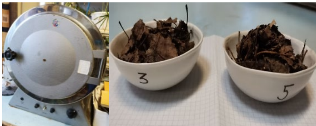
Рис. 3. Визначення вологості компостних зразків
