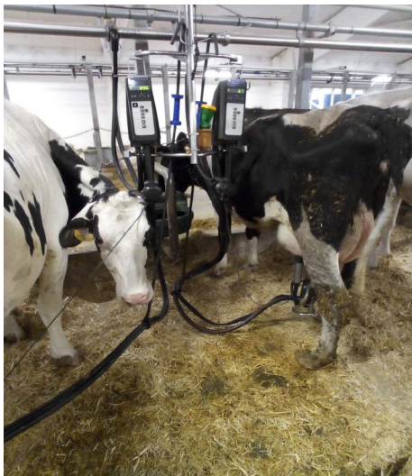
Рис. 2. Доїння корів з використанням системи Дельпро (фірма Деваль)
