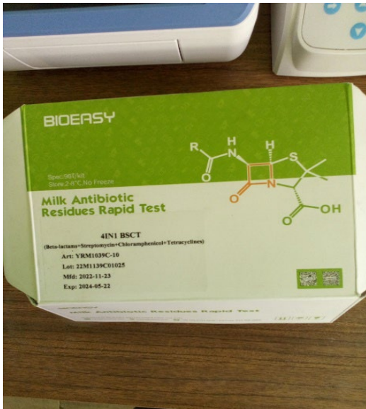
Рис. 4. Набір тест-системи для визначення антибіотиків
